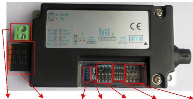
电源端口，外部控制端口，升级口，LED灯，SPEED拨码，6位拨码开关，ACC/DEC拨码
